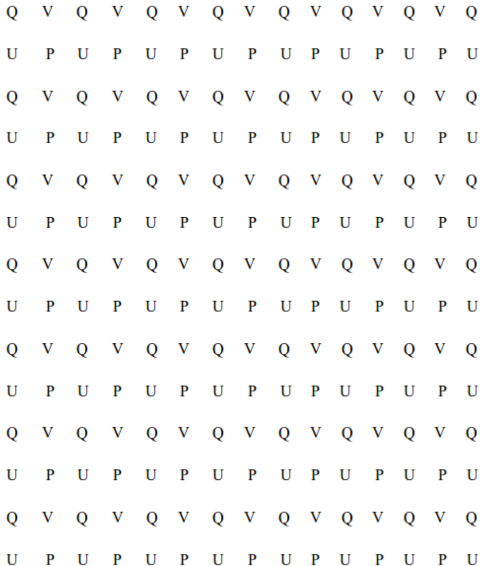
Figura 5.2: Malla horizontal en HYCOM, tipo Arakawa C. Los puntos de malla Q corresponden a escalares, U y V son componentes de momento y P corresponde a la componente de presión
